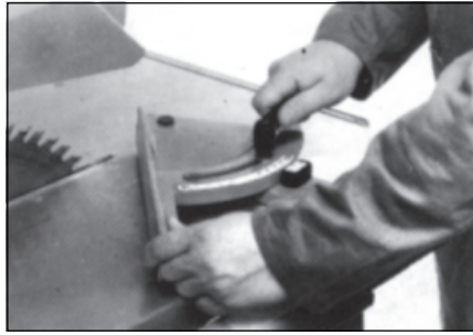
B Volcar el tope angular hacia arriba y ajustar a la cantidad de grados deseada.
